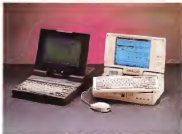
caso del 286L e in una di 128 Kbyte (AAV) nel caso del 286C. La dotazione di interfaccia comprende porte seriali e parallele, oltre ad un'uscita video per monitor esterni. VGA nel caso del 286C. In entrambi i casi sono disponibili due slot di espansione a 8 bit per l'inserimento di schede corte e vero fondo
